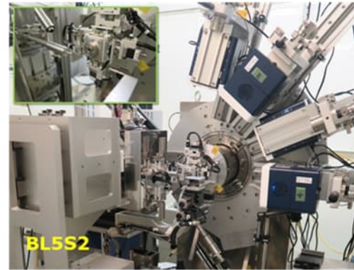
あいちシンクロトロン BL5S2 粉末回折実験ステーション
