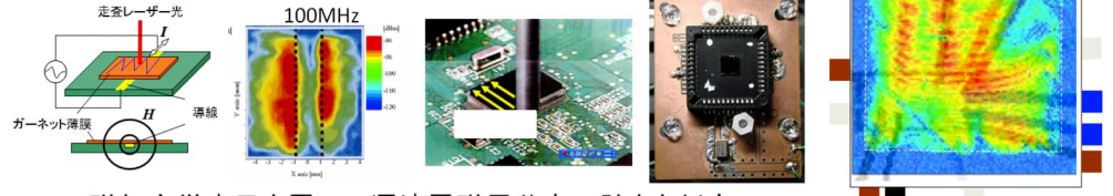
磁気光学素子を置いて漏洩電磁界分布の強さを判定。
