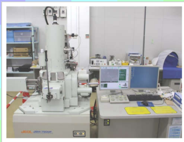
電子顕微鏡(SEM) メーカー:日本電子株式会社 型式:JSM-7600F 分解能:1nm 倍率25~1,000,000倍 EDS・STEM対応
