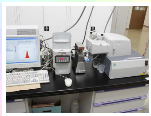
粒度分布測定装置 メーカー:マイクロトラック・ベル株式会社 型式:MT3300EX II 測定範囲:0.02~2,000 \mu m 極小容量循環器付き・有機溶媒に対応可能
