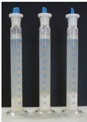
Fig. 2 沈降法（水篩）による分級
