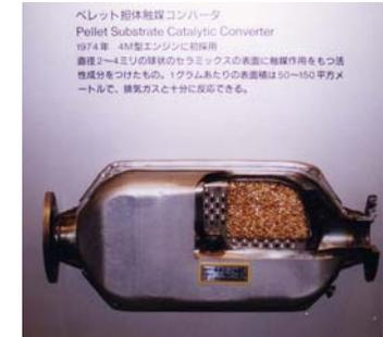
当時、世界一厳しい53年排出ガス規制に対応するため同時に酸化・還元処理する三元触媒装置(トヨタ自動車)。
