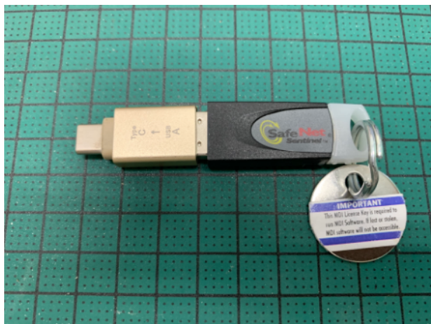
図3 JADE PRO のソフトウェア保護ドングル。本体は USB-A (オス) 仕様だが、USB-C (オス) -USB-A (メス) アダプタを接続した状態で撮影した。
