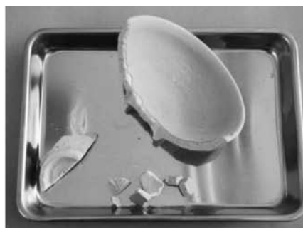
図 11 施釉未焼成試料およびその表面
