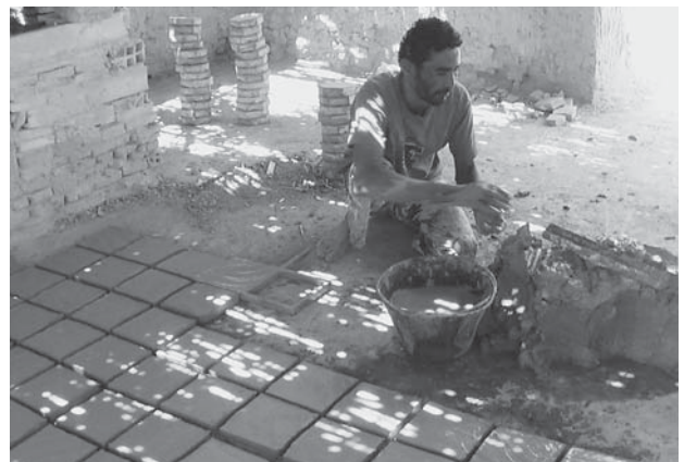
図6 トズールレンガの伝統的製法
